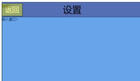
图 6-10-3 嵌入窗口控件显示位置示例（定义窗口大小 480x222）
