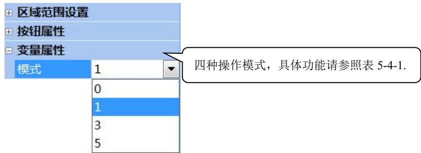
图 5-4-7 硬件参数配置按钮属性设置
