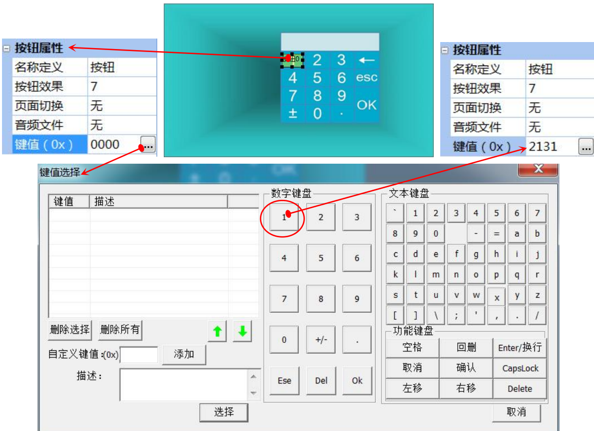
图 5-3-2 数字键盘按钮 1 的键值设置过程
